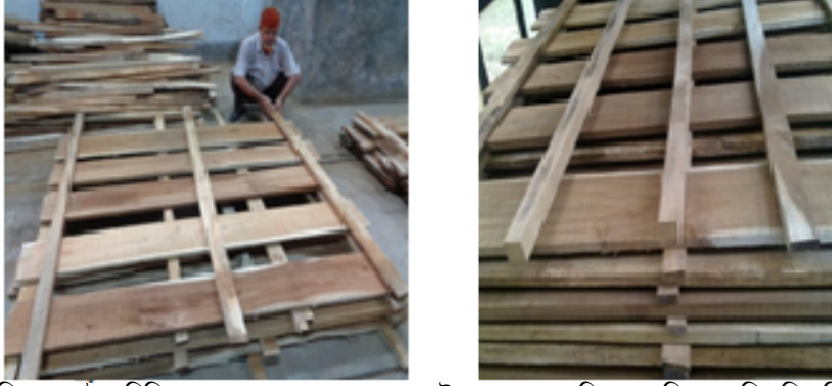
চিত্র ২: হাইব্রিড একাশিয়া কাঠের বিভিন্ন পুরুত্বের তক্তার এয়ার ড্রাই ও সোলার কিলন কন্ডিশনে সিজনিং সিডিইল নির্ণয়ে ব্যবহৃত নমুনা
