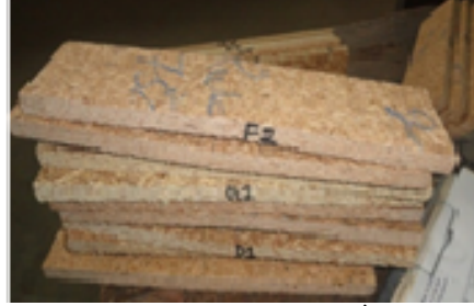
চিত্র ৮: রাজকড়ই এবং রাবার কাঠের কুঁচির পার্টিকেলবোর্ড
