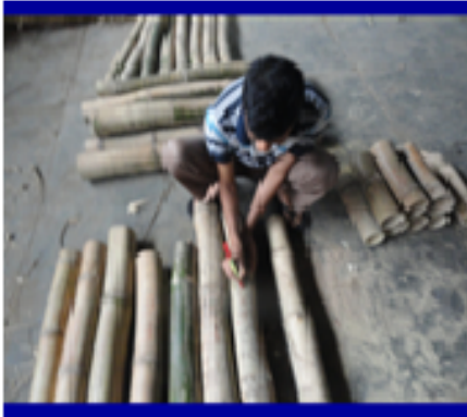
চিত্র ৮: সংরক্ষণ করার পূর্বে প্রস্তুতকৃত বাইজ্যা বাঁশ
